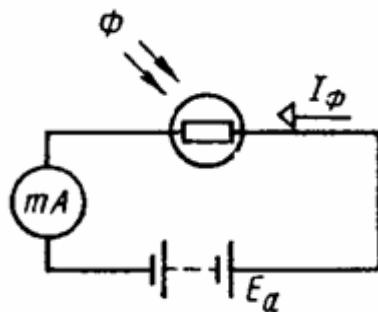
При освещении фоторезистора ток в цепи сильно возрастает. Разность токов при наличии и отсутствии освещения называется световой ток или фототок, величина которого зависит от интенсивности освещения, величины приложенного напряжения, а также от вида и размеров полупроводника, используемого в фоторезисторе.
