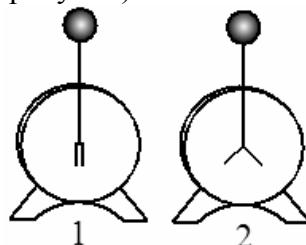
Он обратил внимание учащихся, что после соединения пластмассовым стержнем шаров электрометров совершенно ничего не происходит (т.е. второй электрометр остаётся незаряженным). При соединении шаров электрометров металлическим стержнем заряд со второго электрометра частично переходит на первый.
